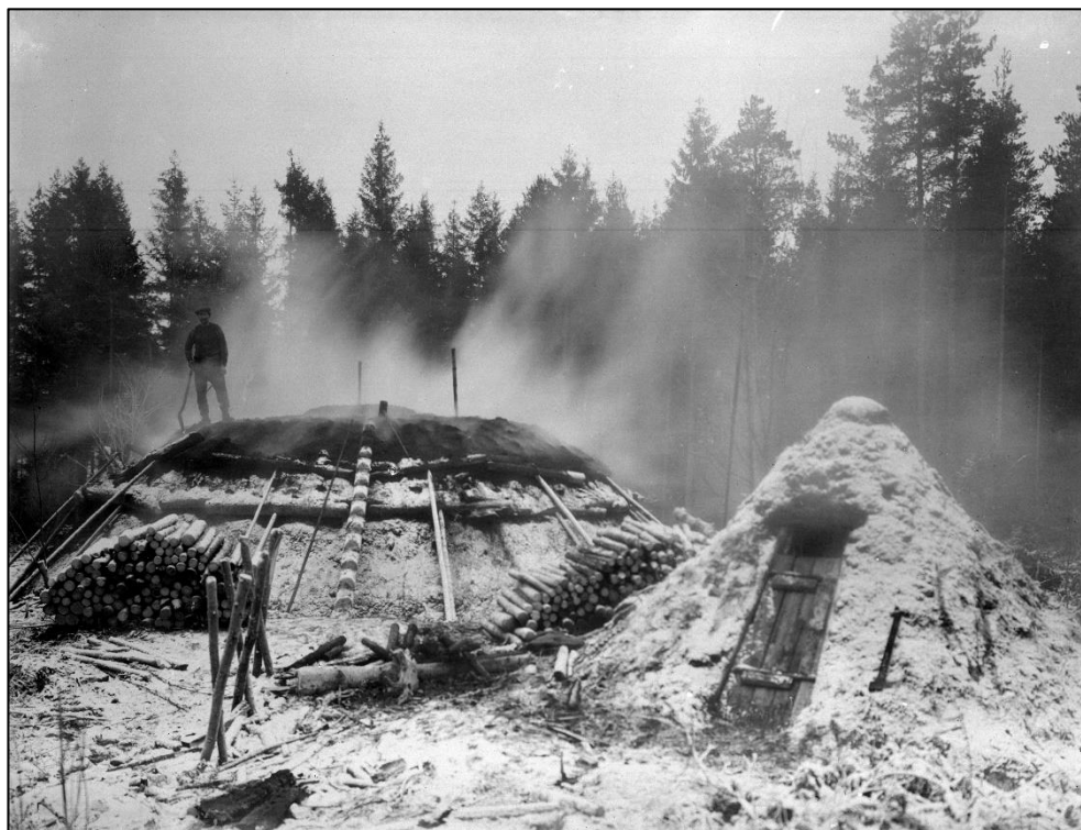
Figur 21. Kolning i resmila till vänster och kolarkoja till höger. Exempel från Närke år 1918. Fotograf: Samuel Lindskog (1872-1953) (Örebro läns museum samlingar, utgången upphovsrätt).
